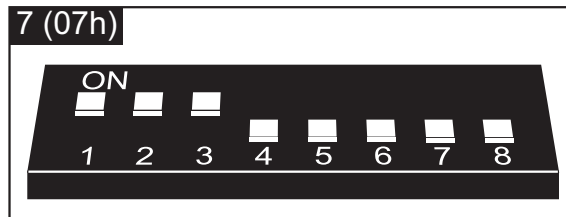
Rys. 13. Sposób ustawienia adresu w ekspanderze INT-RX.
