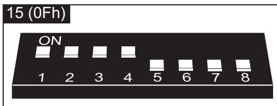
Rys. 21. Sposób ustawienia adresu w ekspanderze wyjść.
