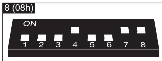
Rys. 16. Sposób ustawienia adresu w kontrolerze ACU-100.
