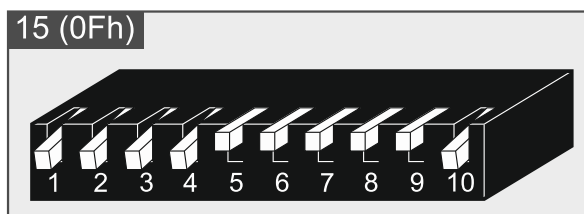
Rys. 11. Sposób ustawienia przełączników DIP-switch w ekspanderze INT-ORS.
