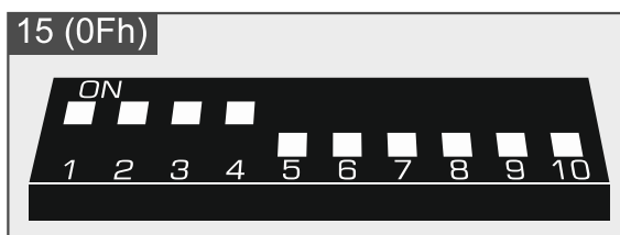
Rys. 10. Sposób ustawienia przełączników DIP-switch w ekspanderze INT-O.
