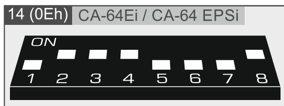
Rys. 15. Sposób ustawienia przełączników DIP-switch w ekspanderach, jeśli mają one zostać zidentyfikowane jako CA-64 Ei / CA-64 EPSi.
