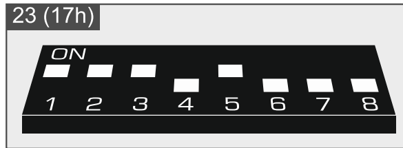
Rys. 20. Sposób ustawienia adresu w module INT-VG / ekspanderze CA-64 SM. Nagrywanie komunikatów głosowych jest zablokowane (przełącznik 8 w pozycji OFF).
