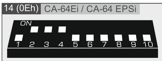
Rys. 15. Sposób ustawienia przełączników DIP-switch w ekspanderach, jeśli mają one zostać zidentyfikowane jako CA-64 Ei / CA-64 EPSi.
